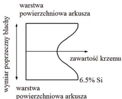
Rysunek 3. Schematyczne przedstawienie profilu zawartości krzemu w arkuszu blachy JNHf
