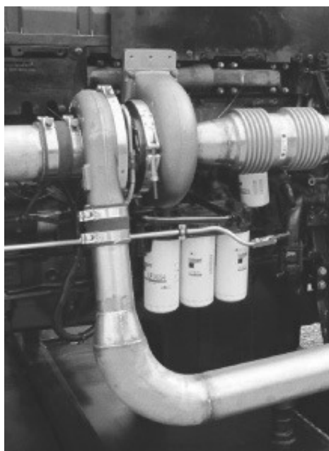
Rys. 1.3.4 Widok systemu rekuperacji energii ze spalin firmy Bowmanpower uk [5].
