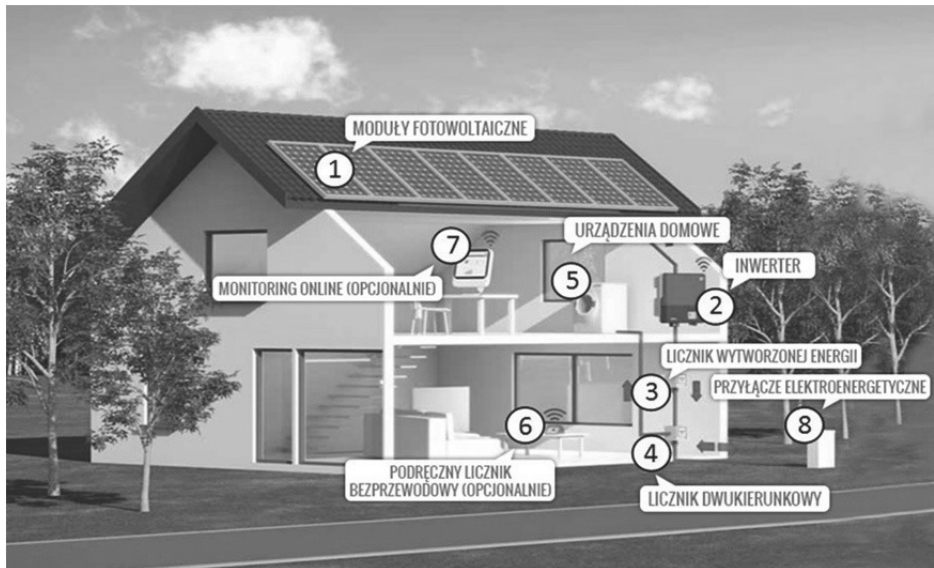
Rys. 2.4.2. Podzespoły i rozmieszczenie elementów instalacji fotowoltaicznej, [2]
