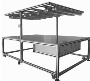
Rys. 3.4.2. Przykład stanowiska do wizualnej inspekcji [10]
