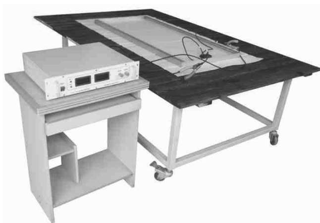
Rys. 3.4.5. Przykład stanowiska do testu przeciążenia prądem wstecznym [10]
