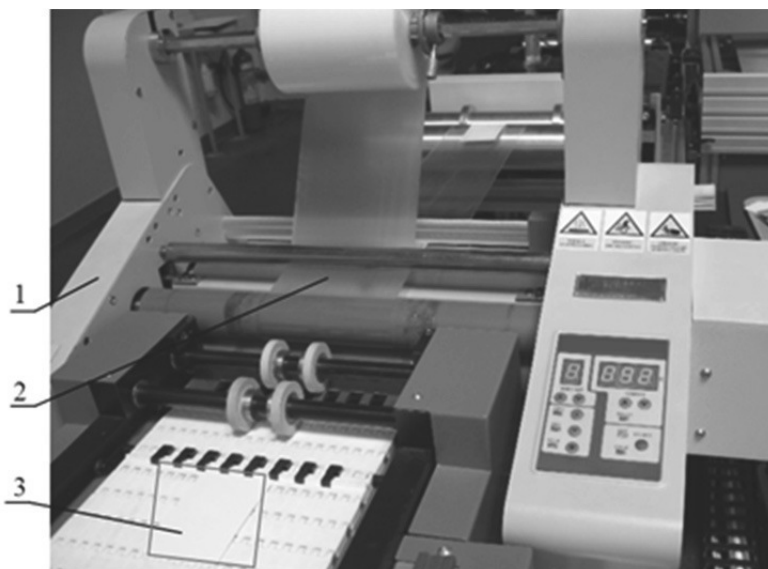
Rys. 3.2.2. Widok modułu laminującego stanowiska; 1 – laminarka, 2 – taśma laminująca, 3 – karta laminowana
