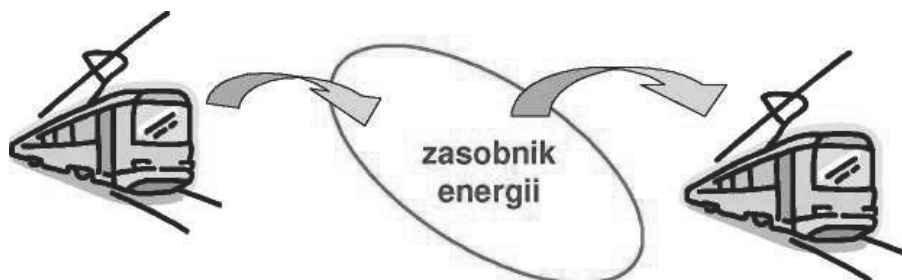
Rys.1.2.2. Poglądowy układ odzyskiwania energii hamowania tramwaju z zastosowaniem superkondensatorów [5].
