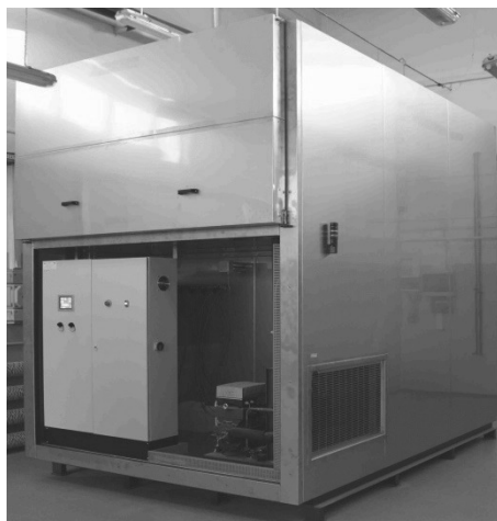
Rys. 3.4.8. Widok stanowiska do badań modułów PV w warunkach wilgotnego gorącego powietrza, produkcji ITeE-PIB
