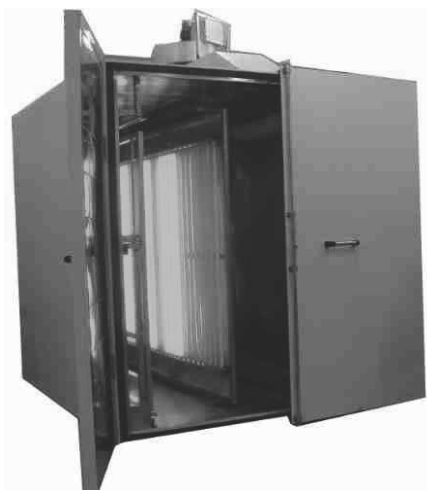
Rys. 3.4.7. Widok stanowiska do badań wstępnych na odporność UV [13]
